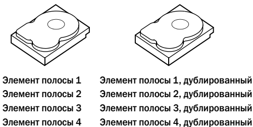
Рисунок 1-2. Пример зеркалирования дисков (RAID 1)
