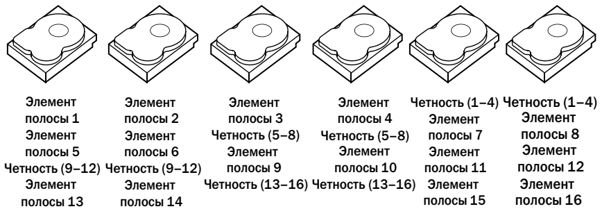
Рисунок 1-4. Пример двойной распределенной четности (RAID 6)
